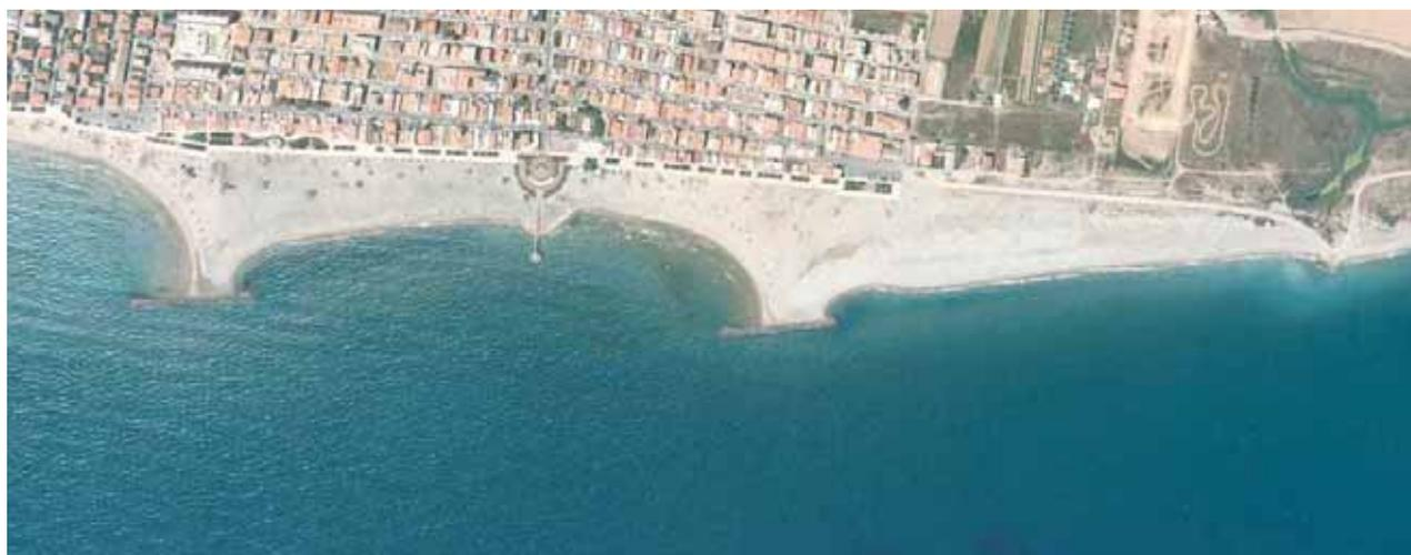
FIGURA 5. Diques exentos en la playa de Chilches y efecto del transporte longitudinal de sedimentos.
